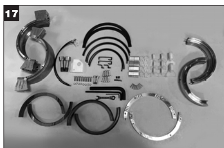
Wyjąć wszystkie elementy zestawu części zamiennych z opakowania i umieścić na czystej powierzchni roboczej.
