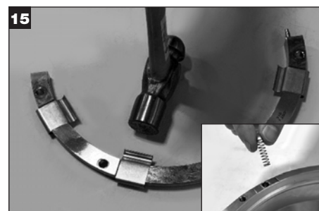
Wymontować sprężyny śrubowe z dławnicy i sprężyny z połówek płyty sprężynowej. Sprężyny można wymontować wybijając z płyty sprężynowej małym młotkiem o połowie wewnętrznej średnicy.
