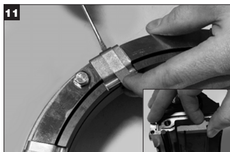
Usunąć (6x – 8x) ustalacze sprężynowe z połówek dławnicy. Uwaga: Po usunięciu ostatniego ustalacza można zdjąć nieruchomy pierścień uszczelniający.
