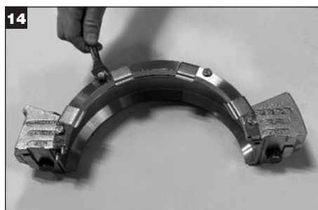
Usunąć (8x) śruby z łbem sześciokątnym, które łączą płytę sprężynową z dławnikiem. Zdjąć połówki płyty sprężynowej z połówek dławnicy.
