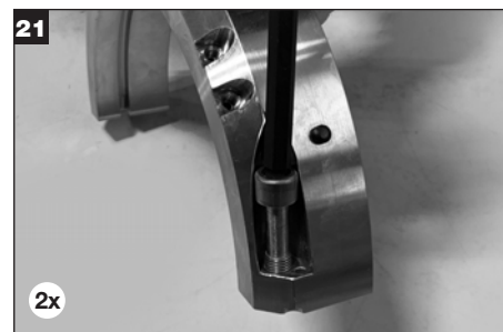
Nasmarować gwinty zalecanym środkiem przeciwzatarciowym i wkręcić śruby z łbem walcowym obejmę a połowce obejmę obrotowej.
