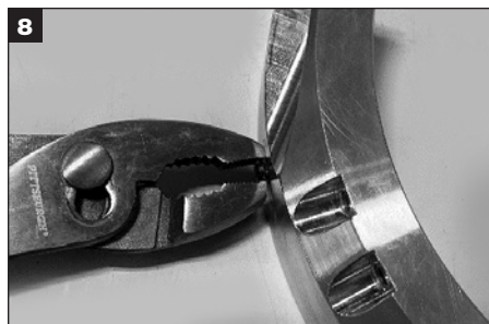
8 Usunąć przyciski centrujące (6x) z zewnętrznego obwodu obejmy obrotowej.
