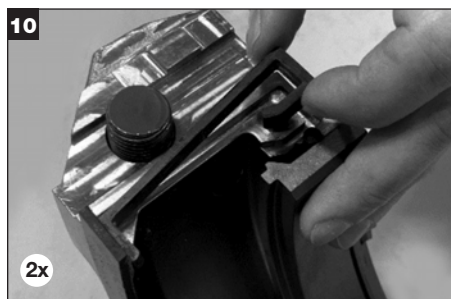
Wyjąć uszczelki dławnicy z rowków dławnicy.
